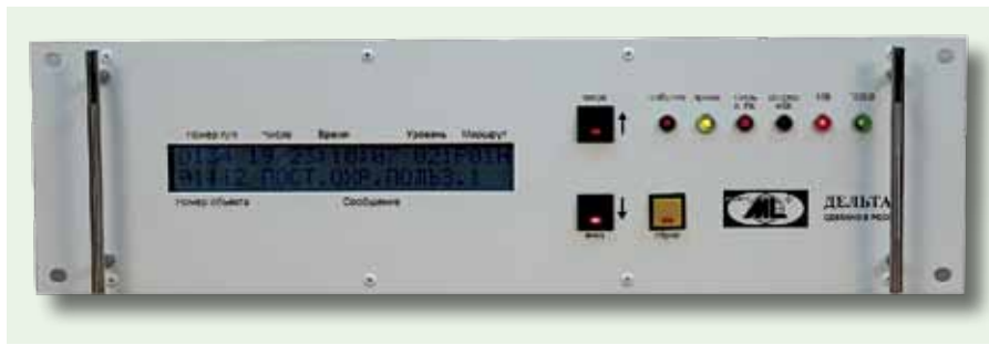
Базовая станция VHF диапазона
