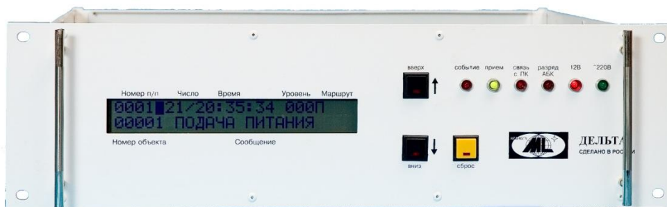
Базовая станция VHF диапазона
