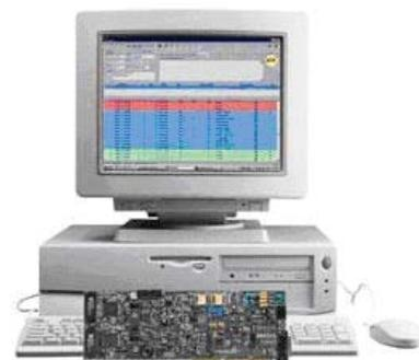
Телефонная базовая станция в виде платы+ПК+ПО АРМ
